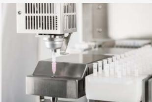
Säule wird in ThermELUTE™ Modul positioniert.
