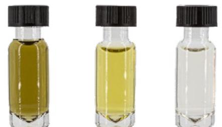
Vergleich der Reinigungswirkung eines Avocado-Rohextrakts (links) mit der Probe nach dispersiver Reinigung (Mitte) und nicht-dispersiver Reinigung mit Pestizid III (rechts)
