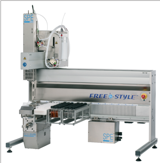
Abb. 1: Freestyle – XYZ-Robotik System für die Probenvorbereitung
