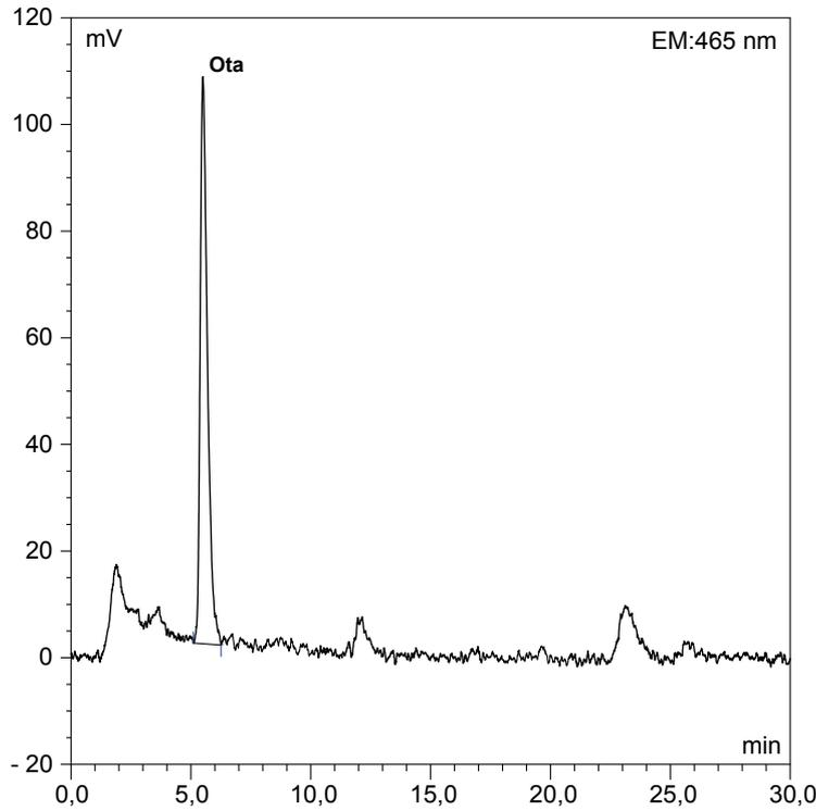
Überlagerung des Probenchromatographen mit Standard
