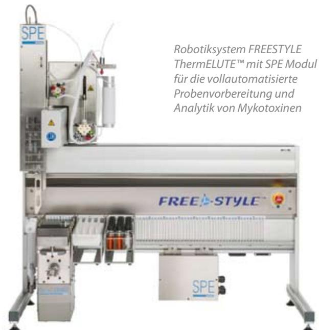
Robotiksystem FREESTYLE ThermELUTE™ mit SPE Modul für die vollautomatisierte Probenvorbereitung und Analytik von Mykotoxinen
