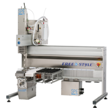
Automatisierte Aufreinigung mit dem Robotiksystem FREESTYLE ThermELUTE™
