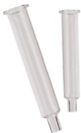
Eine Vielzahl an erhältlichen SPE-Säulen besteht aus Kunststoff. Aufgrund von Wechselwirkungen mit den Analyten oder einer Freisetzung von Störstoffen aus dem Kunststoff kann dieser Säulentyp aber für viele Applikationen nicht eingesetzt werden.
